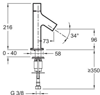
Спецификация продукта: Смеситель. E10378RU. Коллекция: TALAN. Вес: 2,1 кг. Тип установки: 1 отверстие. Расход воды: 8 л/мин. Подключение: С гибкой подводкой. Механизм: Последовательный керамический картридж. Последовательный керамический картридж. Скрытый аэратор с антиизвестковым покрытием.
