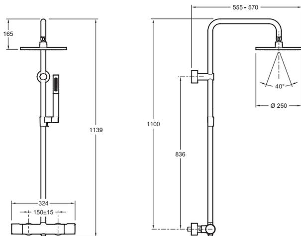
Спецификация продукта: Душевая колонна с термостатическим смесителем и круглым верхним душем 250 мм. E8993. Коллекция: TOOVI. Вес: 8 кг. Круглый вращающийся верхний душ: 250 мм, тонкий. Двухрежимный ручной душ Shift Ellipse.
