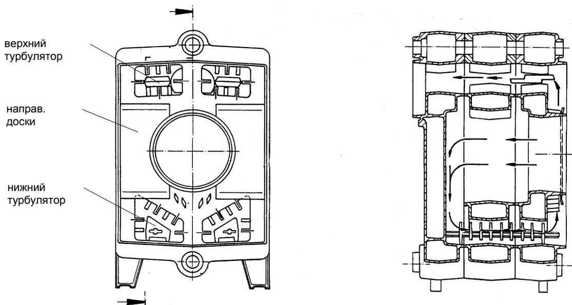
**Рис. 5 Поток продуктов сгорания в корпусе котла**
