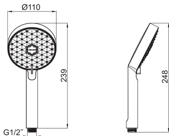
Спецификация продукта: Трехрежимный ручной душ. E72415RU. Коллекция: AWAKEN. Трехрежимный ручной душ, диаметр 110 мм, геометрический дизайн.
