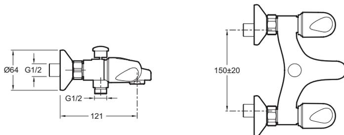
Спецификация продукта: Настенный смеситель для ванны/душа. E71920. Коллекция: GALEO CD. Вес: 1,4 кг. Расход воды: 20/13 л/мин при давлении 3 бар. Механизм: Кран-буксы с керамическим диском. Разметка отверстий:  $150 \pm 20$  мм. Металлические ручки. Автоматический переключатель. Обратный клапан на выходе для душа.
