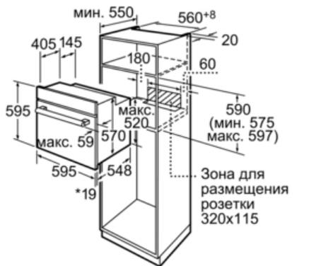
\*При металлической фронтальной панели 20 мм
