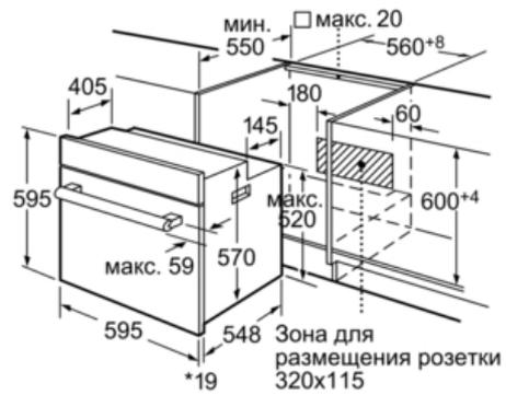
\*При металлической фронтальной панели 20 мм
