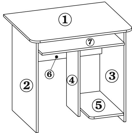
1.1. Закрепить на боковые торцы выкатной полки №7 ответные планки направляющих (Г-2) с помощью шурупов 3,5x16 роликами назад.
