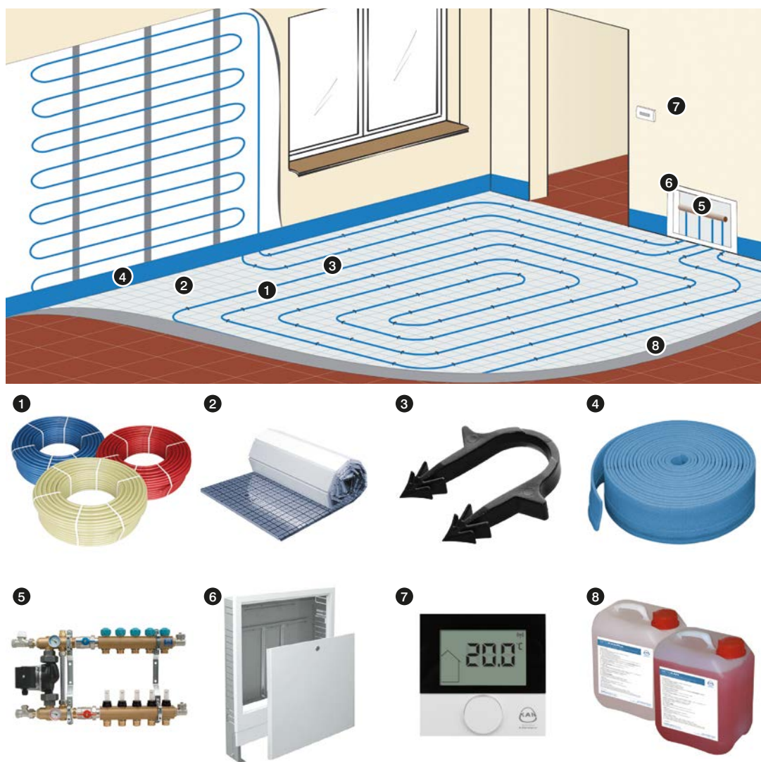
Рис. 46. Элементы панельного отопления/охлаждения KAN-therm
